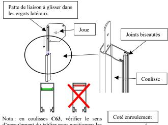
d'enroulement du tablier pour positionner les coulisses dans le bon sens Si enroulement extérieur, positionner la coulisse
