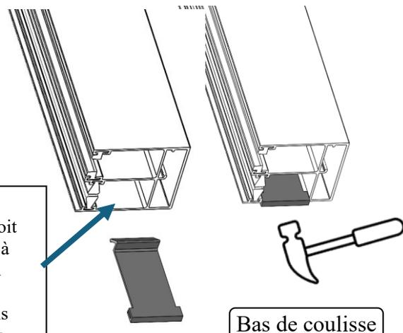
L'arrêt de moustiquaire doit être positionné à l'intérieur de la coulisse côté menuiserie, puis enfoncé à l'aide d'un marteau.
