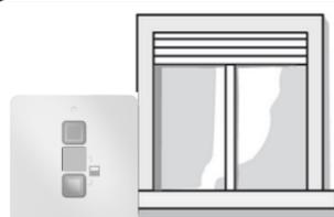
a) Prendre la télécommande du Volet, le descendre et laisser 4 lames apparentes.
