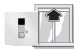
d) Prendre la télécommande du Volet, appuyer sur le bouton **Montée** et laisser le Volet s'arrêter de lui-même.
