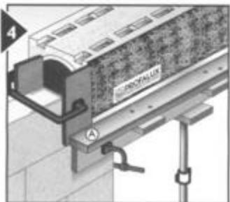
4 Fixer une planche (A) intérieur et extérieur le long du COFFRALUX pour éviter le cintrage lors du coulage du linteau. Vérifier que le coffre soit de niveau.
